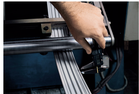
Контроль качества профиля в течение экструзионного процесса
