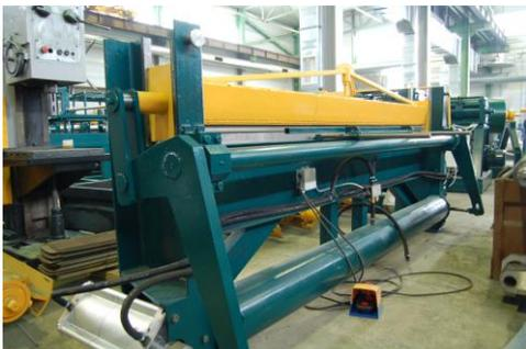
Гибочный станок с пневматическим приводом ЛГСП-27 создан для производства деталей из тонколистового металла толщиной до 1,2мм (до 1,5мм) в заводских условиях.
