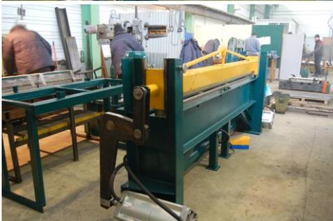
Станок позволяет изготавливать детали различной геометрии (в том числе из металла с лакокрасочным покрытием), например, элементы жесткости, элементы обрамления, откосы и другие детали строительных конструкций.
