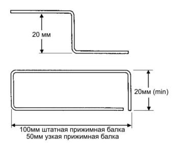
Станок позволяет изготавливать глубокие узкие желоба и глубокие ящики. На рисунке указаны минимальные размеры для этих изделий при использовании стандартной прижимной балки.
