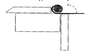
Кроме простых загибов, ручной листогиб ЛГМ-35 позволяет осуществлять радиусные сгибы вокруг вспомогательной круглой заготовки.
