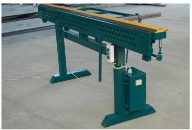
Станок ЛГМ-35 предназначен для гибки стальных, медных, алюминиевых листов толщиной от 0,4 до 1,2мм.
