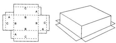
Ящик с перекрывающимися углами изготавливается при соблюдении правильной последовательности сгибов. Сначала, подставляя загибаемые края под прижимную пластину, делаются все сгибы А под углом 90°. Затем, аналогично делаются сгибы В под углом 45°. Далее, используя длинную прижимную пластину, делаются сгибы С под углом 90°. Используя короткие прижимные пластины, завершаются сгибы В до угла 90°.
