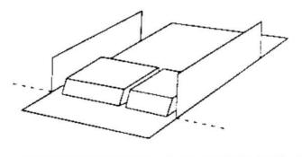
Листогиб ЛГМ-35 идеально подходит для изготовления ящиков и шкафов. Набор коротких прижимных пластин значительно упрощает выполнение сложных сгибов. Для изготовления ящика необходимо подобрать по длине одну или несколько пластин, соединенных вместе, как показано на рисунке.
