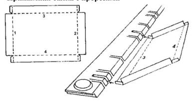
В комплект поставки листогиба может быть включена специальная прорезная прижимная балка с пазами шириной 8мм и глубиной 40мм, позволяющих изготавливать простые короба без использования набора коротких прижимных пластин.
