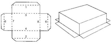
Аналогичным образом изготавливают ящики с простыми углами и выступающими загибами.
