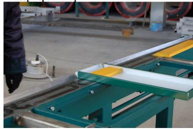
Набор коротких прижимных пластин позволяет изготавливать небольшие сложные детали. В набор стандартных пластин входят длины 50; 70; 140; 280; 597 мм.
