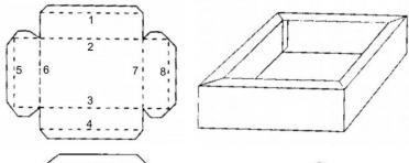
Ящики с загнутыми вовнутрь краями могут быть изготовлены с использованием стандартного набора прижимных пластин. Сначала выполняются сгибы 1,2,3 и 4, затем 5,6,7 и 8.
